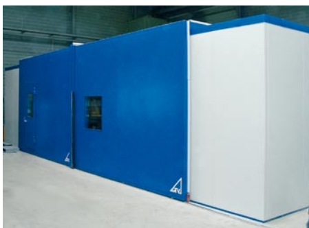
Vue d'ensemble de l'installation avec cabine d'insonorisation, longueur maximale des pièces 10 m
