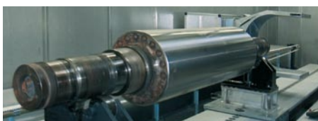
Rouleau cylindrique typique de l'industrie des films, prêt pour le revêtement
