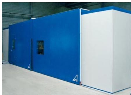
Übersicht der Anlage mit Schallschutzkabine, maximale Bauteillänge 10 m
