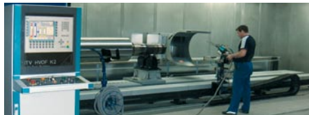
Einrichten des K2-Systems zur Walzenbeschichtung mit Hartmetall
