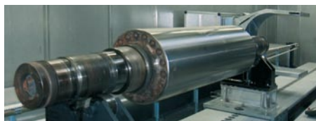
Typische Kalanderswalze der Folienindustrie bereit zur Beschichtung
